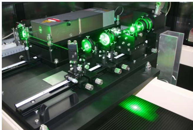
図5 QスイッチパルスYAGレーザー装置とその加工光学系 (ビームスポット径： 30~45 \mu\text{m} )
