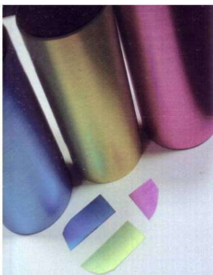
(a) アブレーション加工された小片
