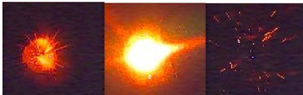
図1 レーザーアブレーション現象（左から照射10ns、20ns、約50ns後）
