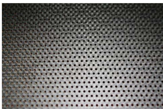
図15 消音パネルへのレーザー穴あけ
