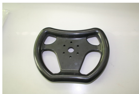
図10 自動車ハンドルのレーザー穴あけ
